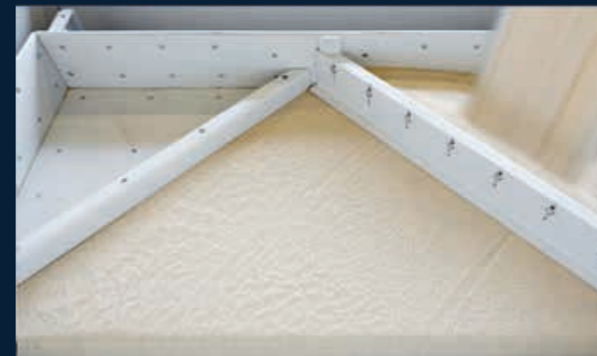
Das Aufgabematerial wird auf der vollen Breite des Siebbodens aufgegeben.
